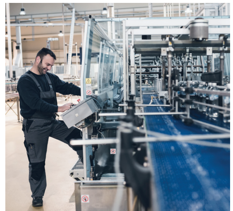
Řídicí panel výkonu tiskárny integrovaný do terminálů výrobní linky
